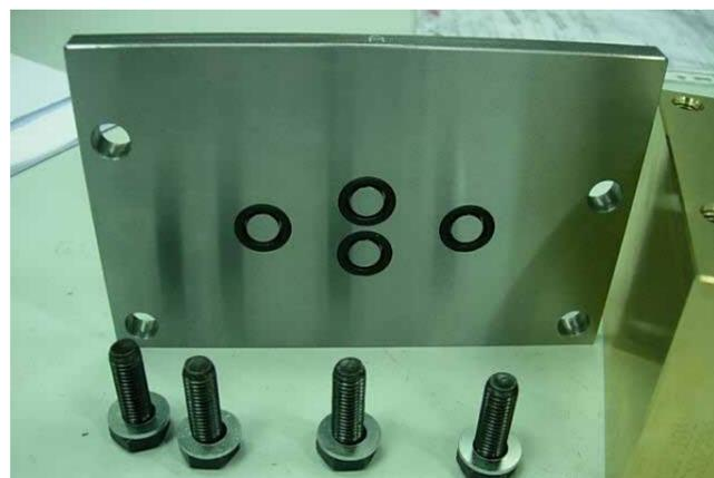
Bloque electrodistribuidor hidráulico fabricado por Útilvigo para el submarino Scorpene
